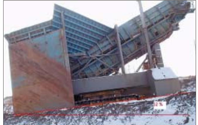
Fig. 13: Bin and apron feeder transport on inclination of 12 % Abb. 13: Transport von Aufgabebunker und Plattenband bei 12 % Neigung
