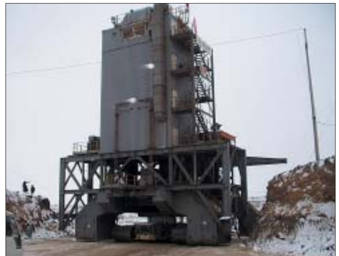
Fig. 15: Transporting the crushing module Abb. 15: Transport des Brechermoduls
